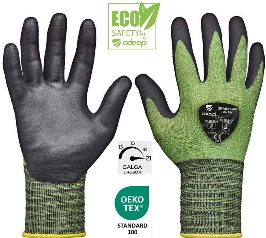
El guante “GRAB21-460” es un guante destinado a la protección frente a agresiones mecánicas, confeccionado con tejido reciclado, de galga 21. La palma y los dedos tienen un recubrimiento muy fino de nitrilo FOAM. Permite una excelente adaptabilidad a la forma de la mano.
